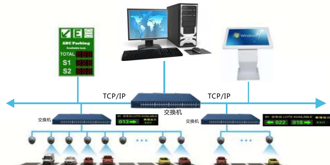
停车场车位诱导系统结构图
